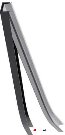
SOLUZIONE CON GUIDA INFERIORE AD AVVITAMENTO ART. 830 + 935 SOLUTION WITH SURFACE-MOUNTED RAIL ART. 830 + 935
